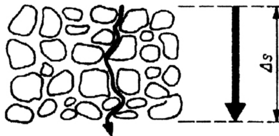
Abb. 8: Abstand \Delta s in genereller Grundwasserfließrichtung (dicker Pfeil) zur Ermittlung der Abstandsgeschwindigkeit und tatsächlichem Fließweg (dünner Pfeil) eines Wassermoleküls; (aus JORDAN & WEDER 1988).
