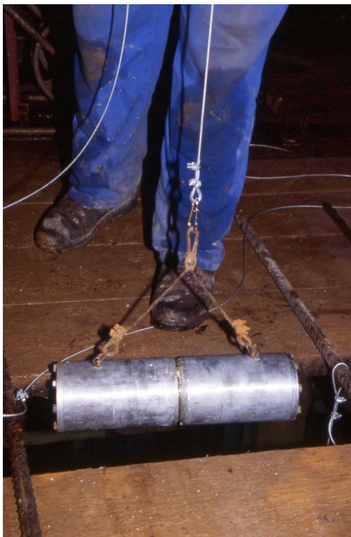
Abb. 16: Ablassen einer LydiA in den Blindschacht des Georgi Unterbau (Foto WOLKERSDORFER)
