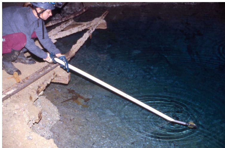
Abb.20: Tracereingabe (Mikrosphären; Farbe: green) in den Großen See (GS) mittels eines Schöpfers.
